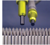
图1. 用玻璃珠以90°角对针管进行喷砂处理，以去除毛刺。
