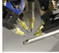
图2. 微喷砂工艺可以去除镍钛诺支架上的氧化层及支柱侧面的再熔物。
